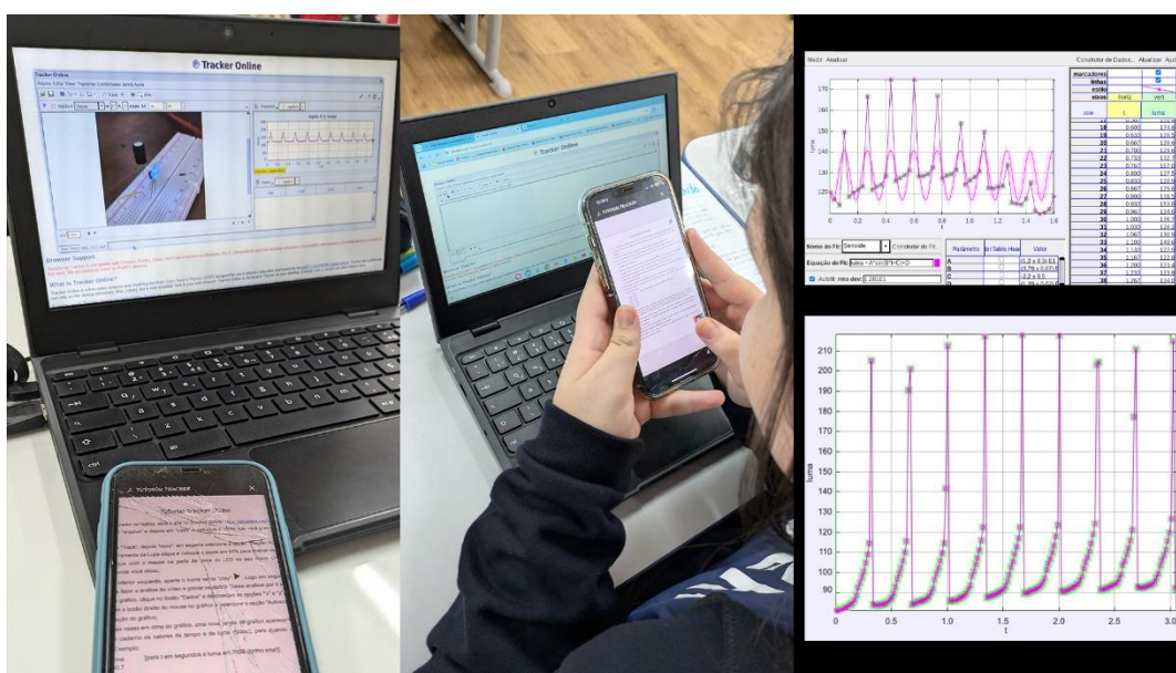
Figura 03: Realização do Momento 5 em sala de aula. Análise dos vídeos capturados com o smartphone pelos estudantes através do software livre Tracker Online. Gráficos de tempo x brilho do LED, gerados pelos estudantes. Fonte: Autoria própria.
